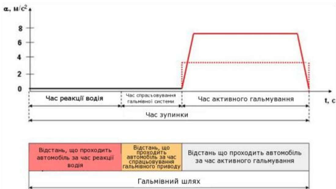
Рисунок 12 – Графічне зображення процесу гальмування
